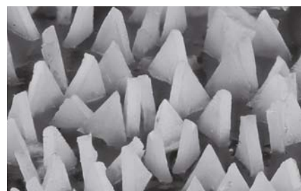
Оптимальное расположение абразивного зерна VICTOGRAIN
