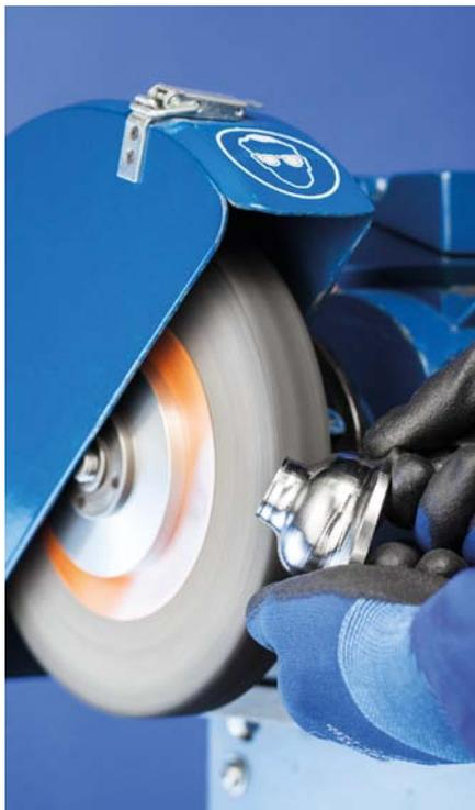
В компактных шлифовальных дисках POLINOX PNK вспененное шлифовальное волокно спирально намотано на сердечник. Такая структура защищает волокно и увеличивает его срок службы, а также усиливает абразивные свойства инструмента.
