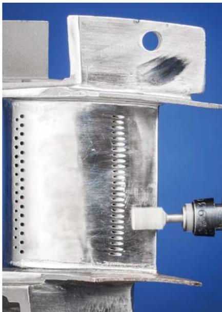
Инструменты для тонкого шлифования Poliflex со связкой ТХ изготовлены с нормальным корундом. За счет текстильных прослоек связка ТХ очень твердая и прочная. Инструменты подходят для обработки кромок.
