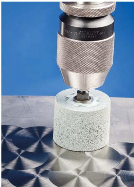
Инструменты для тонкого шлифования Poliflex со связкой PUR изготовлены с зеленым карбидом кремния (SiC). Связка PUR очень мягкая и представлена в двух вариантах твердости (PUR-W, PUR-MH). Абразивное зерно равномерно распределено в связке.
