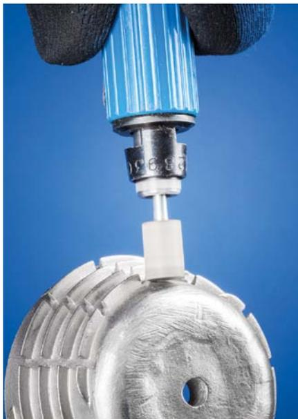
Инструменты для тонкого шлифования Poliflex на связке LR изготовлены с белым высококач. корундом. Связка LR твердая и прочная. Инструменты подходят для обработки поверхностей. Инструменты для тонкого шлифования Poliflex на связке LHR изготовлены со смесью абразивного зерна из белого высококач. корунда и частично из зеленого карбида кремния. Связка LHR твердая и прочная. Инструменты подходят для обработки кромок.
