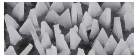
Оптимальное расположение абразивного зерна VICTOGRAIN
