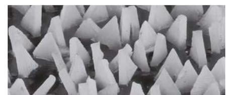
Оптимальное расположение абразивного зерна VICTOGRAIN
